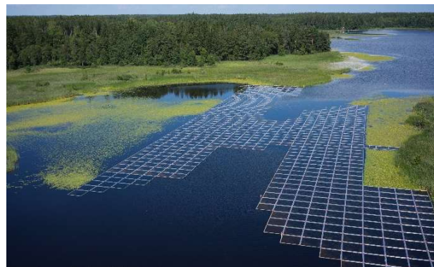
Flytande ramar försedda med duk, för bekämpning av sjögull, foto: Ingmars drönartjänst
